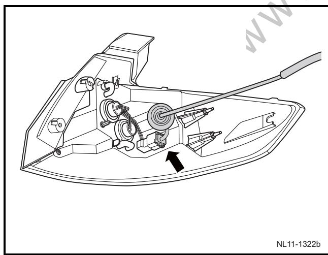
4) 断开后组合灯总成 1 线束连接器。
