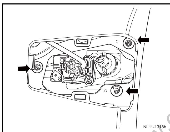
2) 将后组合灯总成 2 对准安装孔，安装 3 个固定螺母。
