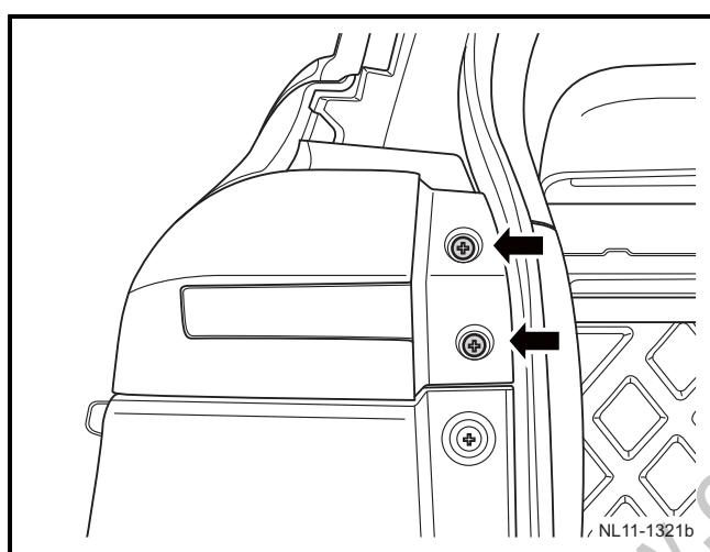
2) 拆卸后组合灯总成 1 上的 2 个固定螺钉。
