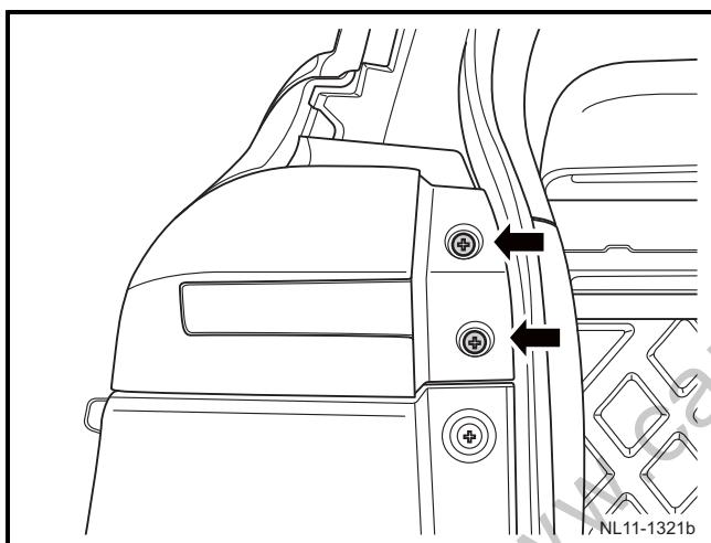
2) 将后组合灯总成 1 对准安装孔，安装 2 个固定螺钉。
