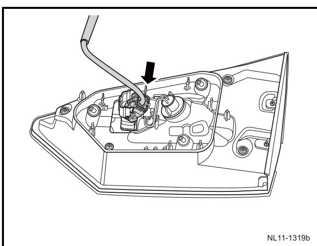
3) 断开后组合灯总成 2 的线束连接器。
